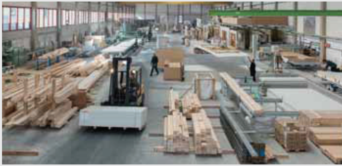
Fertigung von Holzbauelementen mit fermacell Gipsfaser-Platten
