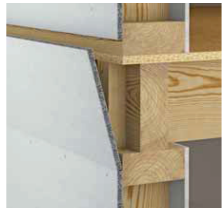
Bild 2: Montage des Plattenstreifens
