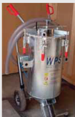
Mörtelpumpe zur Untermörtelung der Schwelle
