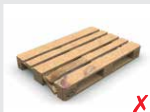
Bruch eines Querbretts
