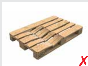
Schäden an mehr als 3 Bauteilen
