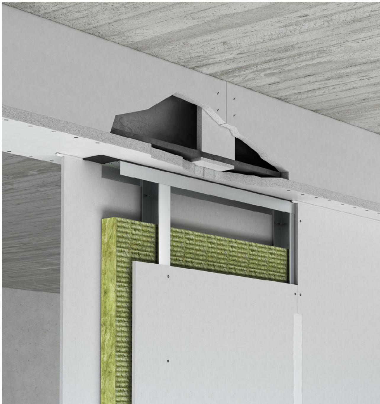
Detaillösungen Anschluss Trockenbauwand an bekleidete Stahlträger
