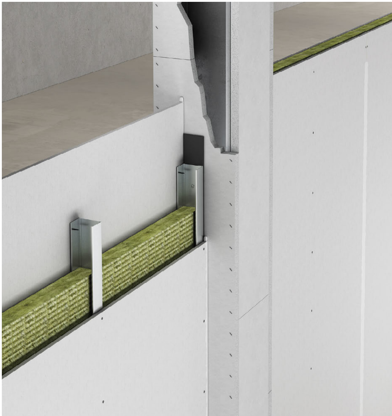
Detaillösungen Anschluss Trockenbauwand an bekleidete Stahlstützen
