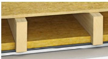
Geschlossene Holzbalkendecke, Unterdecke federnd abgehängt
