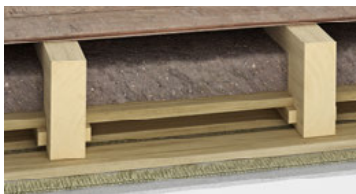
Geschlossene Holzbalkendecke, Einschub nicht tragend
