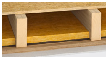
Geschlossene Holzbalkendecke, Unterdecke auf Lattung
