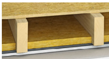
Geschlossene Holzbalkendecke, Unterdecke federnd abgehängt
