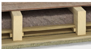
Geschlossene Holzbalkendecke, Einschub nicht tragend
