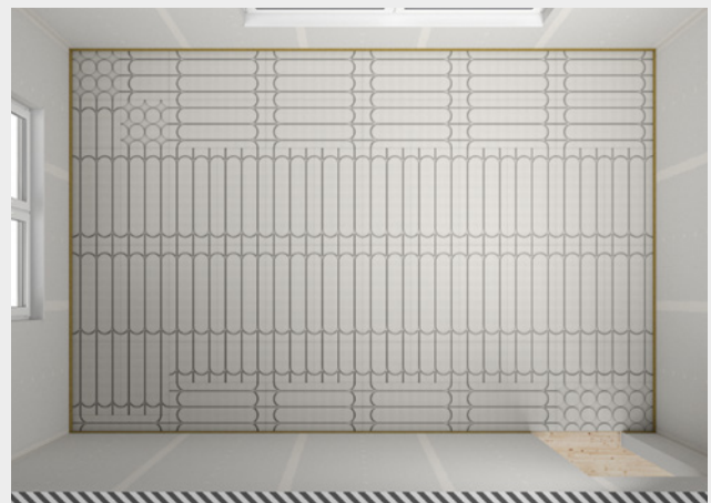
Verlegscheema mit zwei Heizkreisen
