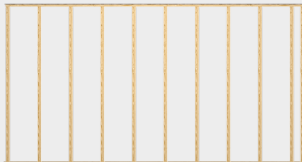
Achsabstand Unterkonstruktion max. 500 mm
